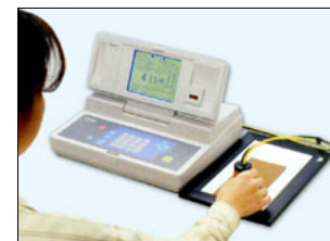
Für Messungen, die dem ASTM D257 Standard entsprechen. U-type J-Box RMJ350
