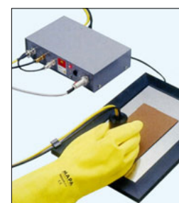
Mit der U-type Switch Box (RMJ352) ist ein Wechsel zwischen der \rho_s und der \rho_v - Messung möglich.
