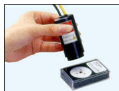
Kontrolle des Messkopfs mit dem Messkopfprüfer vor der Messung.
