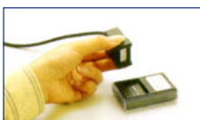
Kontrolle des Messkopfs mit dem Messkopfprüfer vor der Messung
