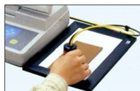
Der Messkopf muss senkrecht zur Probe gehalten werden.
